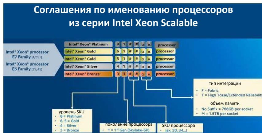
Рис. 1.3. Схема наименований микропроцессоров Intel Xeon Skylake SP.
