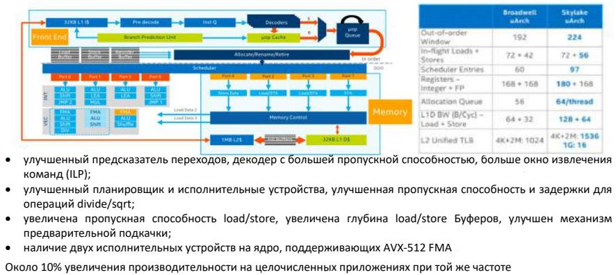
Рис. 1.6. Улучшения микроархитектуры Intel Xeon Skylake SP.
